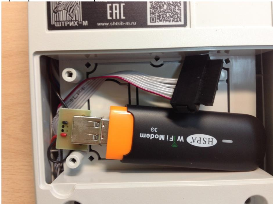
3. Выполнить настройку Табл.10 ККМ, задав Имя сети Wifi, обеспечиваемой данным модемом и Пароль. Таймаут подключения следует увеличить до 60 или более сек.
